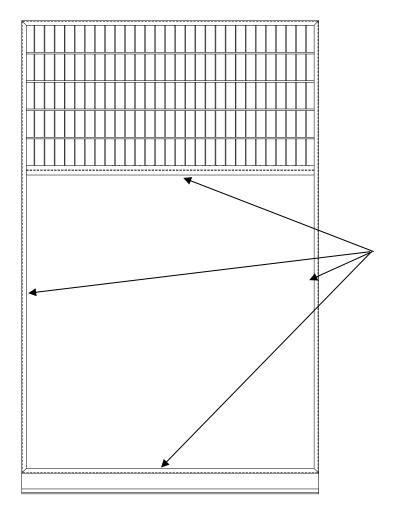
APPLY A BEAD OF SILICON ALONG JOINT WHERE THE STAINLESS OR GALVANIZED STEEL IS INSERTED IN TO THE ALUMINUM FRAMEWORK.
